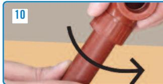
Una vez concluida la introducción, hasta que el material llegue a su punto de fusión definitivo, se dispone de tiempo suficiente para realizar pequeños movimientos de alineación. A partir de ello, por un lapso de dos minutos, se deben evitar esfuerzos de tracción o flexión.
