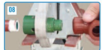
Cumplido el tiempo de calentamiento, retirar simultáneamente el tubo y la conexión, y llevar a cabo la unión.
