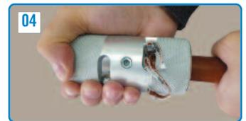
Para el rectificado, se introduce el extremo del tubo en la guía del rectificador, se ejerce una ligera presión y se gira la herramienta en sentido horario hasta hacer tope. No es necesario marcar la profundidad de penetración. El tope del rectificador determina la exacta profundidad.
