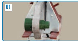
Fijar el termofusor a un banco y ajustar las boquillas a la plancha de aluminio. Controlar el termostato del termofusor; verano 260°C, invierno 270°C. Conectar a la red de 220 volt.
