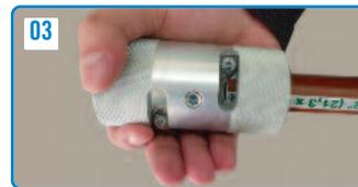
Para fusionar el tubo Hidro 3 Aluminio® deberá rectificarse previamente su diámetro exterior. El rectificador remueve fácil y completamente el sobre espesor conformado por la capa exterior marrón y de aluminio.
