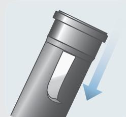
2- Corte un tramo del pase de losa Acustik según el diámetro del tubo.
