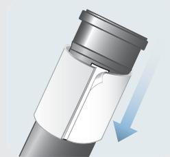
4- Coloque nuevamente cinta adhesiva por fuera, en la unión de los dos extremos del pase de losa Acustik para reforzar la fijación.
